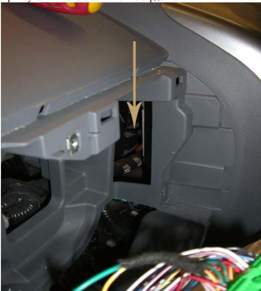
6 Остаётся только питание, зажигание и масса. Под рулём есть дверка за которой живут предохранители, снимается путём поворачивания двух стопоров, и дёрганья на себя. Там видно массу. Она справа в районе сабвуфера.
